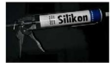
Zum Schutz der Holzteile können Sie rundum die Sockelleiste eine Silikonnaht ziehen.
