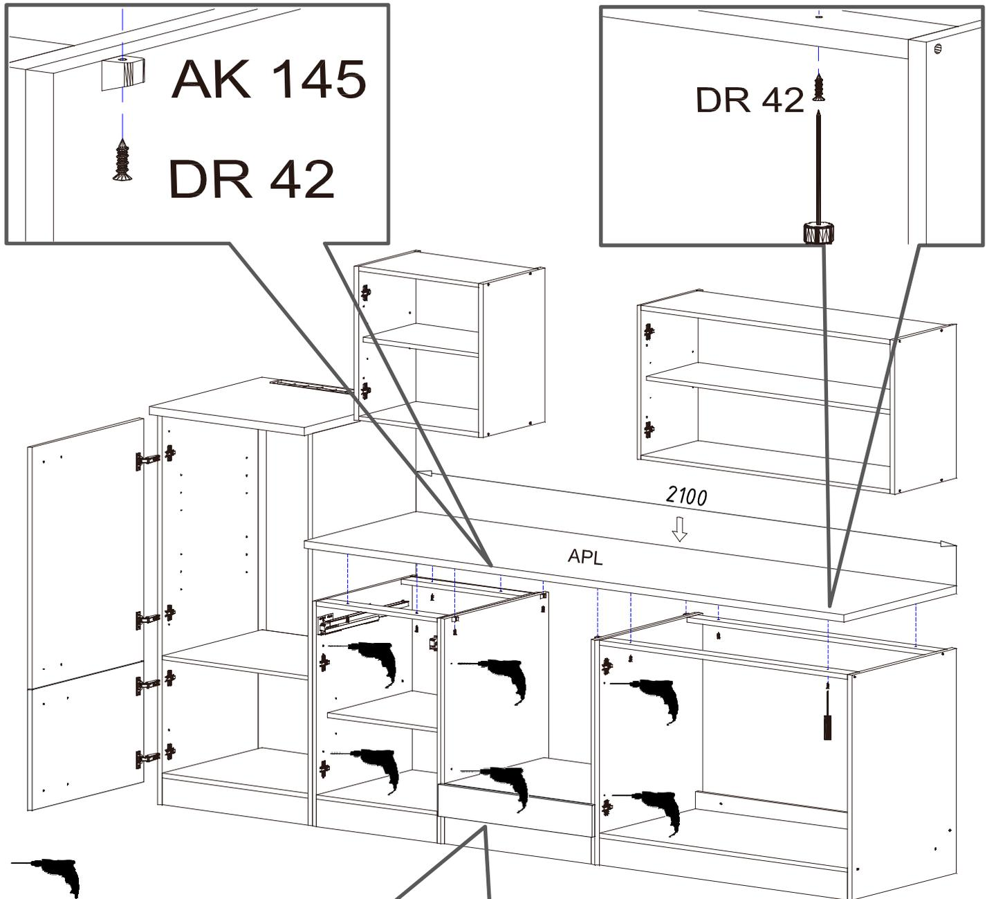
Mit  $\varnothing 5\text{mm}$  Bohrer durchbohren
