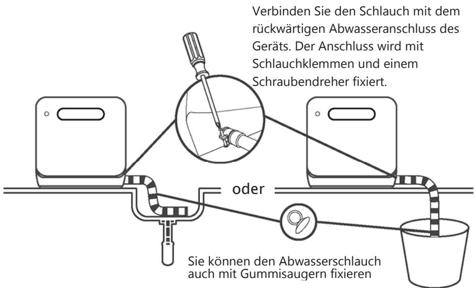
Um den Abwasserschlauch zu installieren, verlegen Sie das Schlauchende in Ihr Spülbecken oder in einen Eimer.
