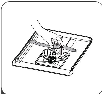
**2** Um den unteren Sprüharm zu entfernen, ziehen Sie den Sprüharm nach oben heraus.
