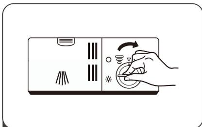
**3** Schließen Sie den Deckel des Klarspülerbehälters durch Drehung im Uhrzeigersinn,
