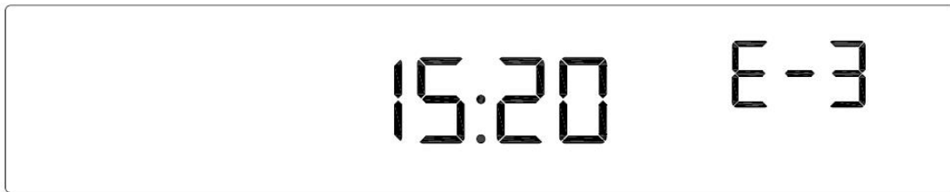
Bild 13: E-3 Türsperre defekt
