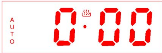
Abb. 18: Ausschalten des Automatiksymbols (wenn Gardauer abgelaufen)
