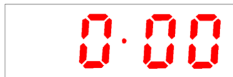
Abb. 5: Standarduhranzeige beim Einschalten (Standby-Modus)
