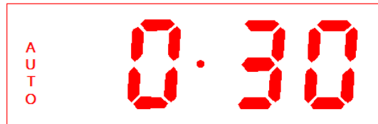
Abb. 18: Ausschalten des Automatiksymbols (wenn Gardauer abgelaufen)
