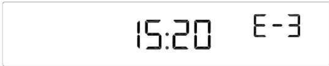
Bild 13: E-3 Türsperre defekt
