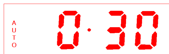
Abb. 25: Anfangsanzeige der Garzeitprogrammierung
