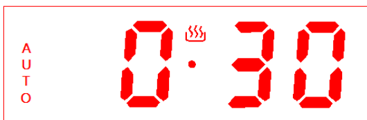
Abb. 30: Ausschalten des Automatiksymbols (wenn Garzeitende erreicht)
